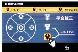
5. 調整噴頭的高度直到可以輕觸住紙張，同時每次調整時檢查紙張是否可以移動，一但紙張被夾到太緊以至於無法移動，回到主選單並點擊
