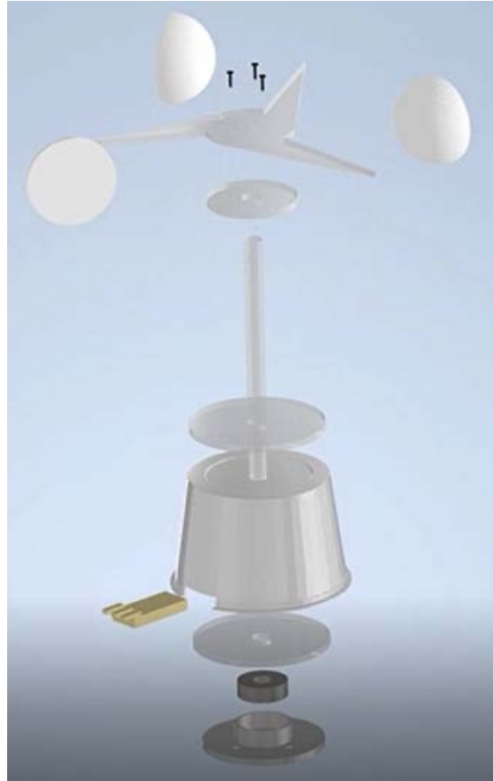
圖 23 風速計爆炸圖
