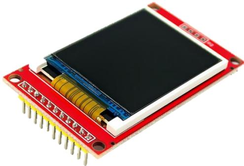
圖 22 TFT LCD 顯示器
