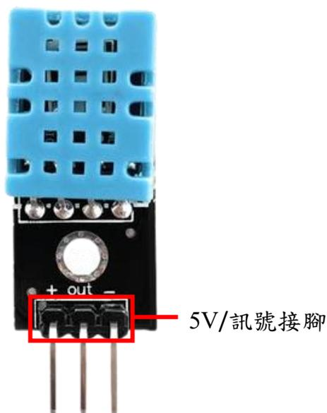
圖 7 DHT-11 接腳圖
