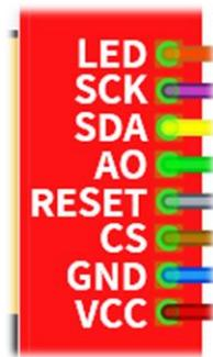
圖 21 TFT LCD 顯示器 接腳圖
