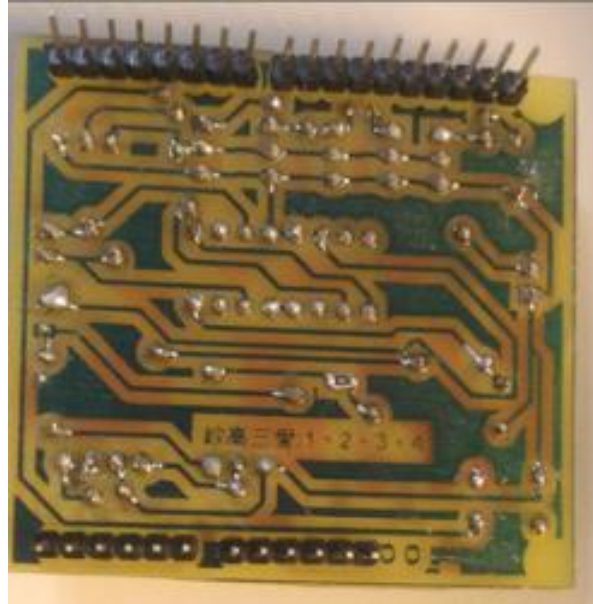
圖 13 Arduino 擴充板焊接圖 Bottom Layer
