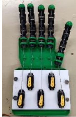
圖 25 由線帶帶動機械手臂的手指
