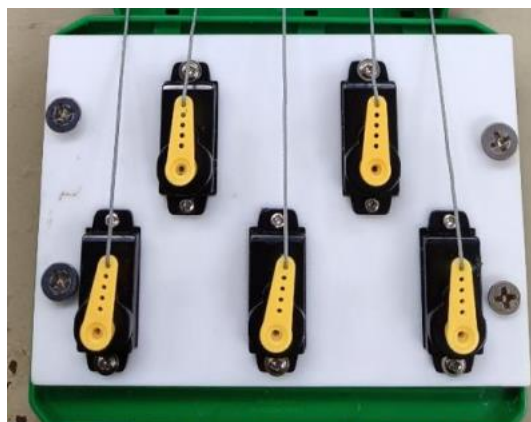
圖 20 連接馬達與機械手臂的支架
