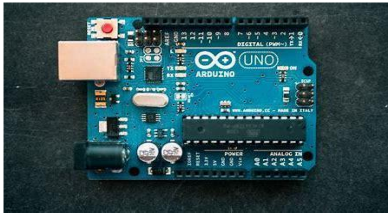
圖 3 Arduino Uno 開發板
