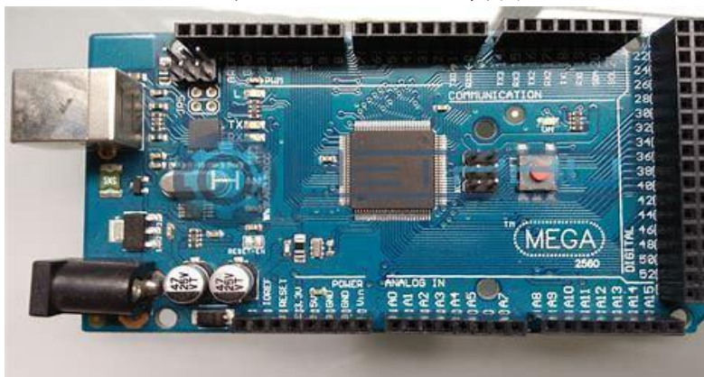
圖 4 Arduino MEGA2560 開發板
