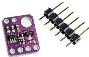
圖 9 VL53L0X 飛時測距感測器
