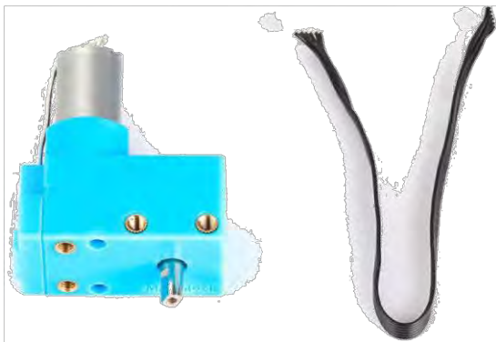
圖 二-7 180 光電編碼器馬達零件圖
