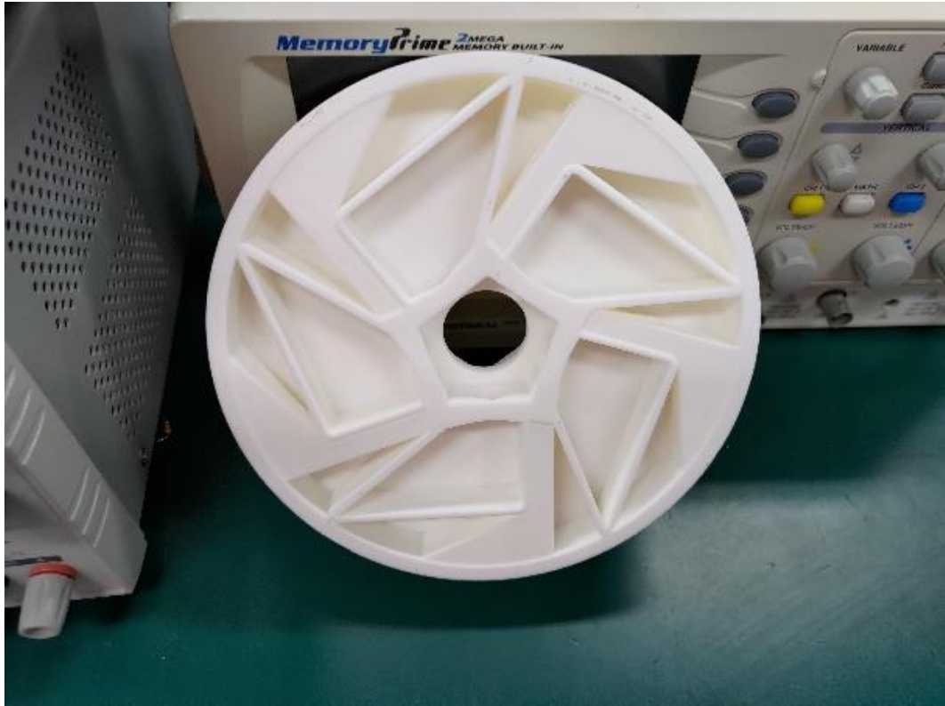
圖 3-5 3D 列印製成主輪（資料來源：自行拍攝）
