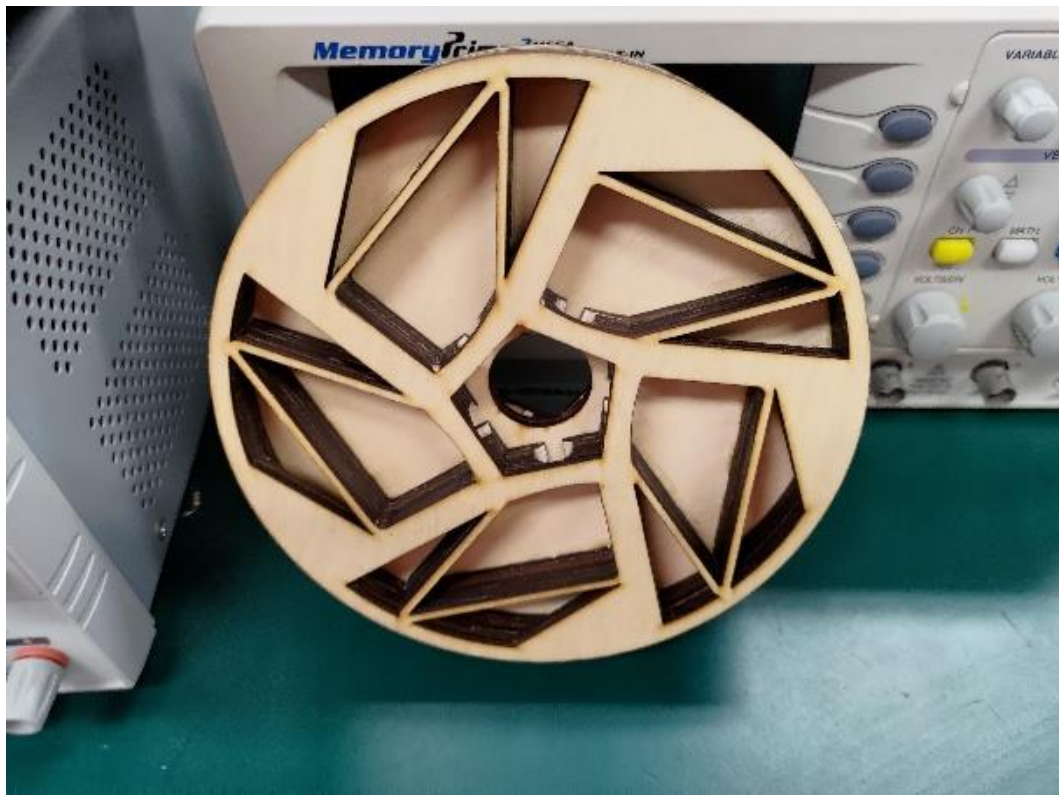
圖 3-4 雷射切割製成主輪（資料來源：自行拍攝）
