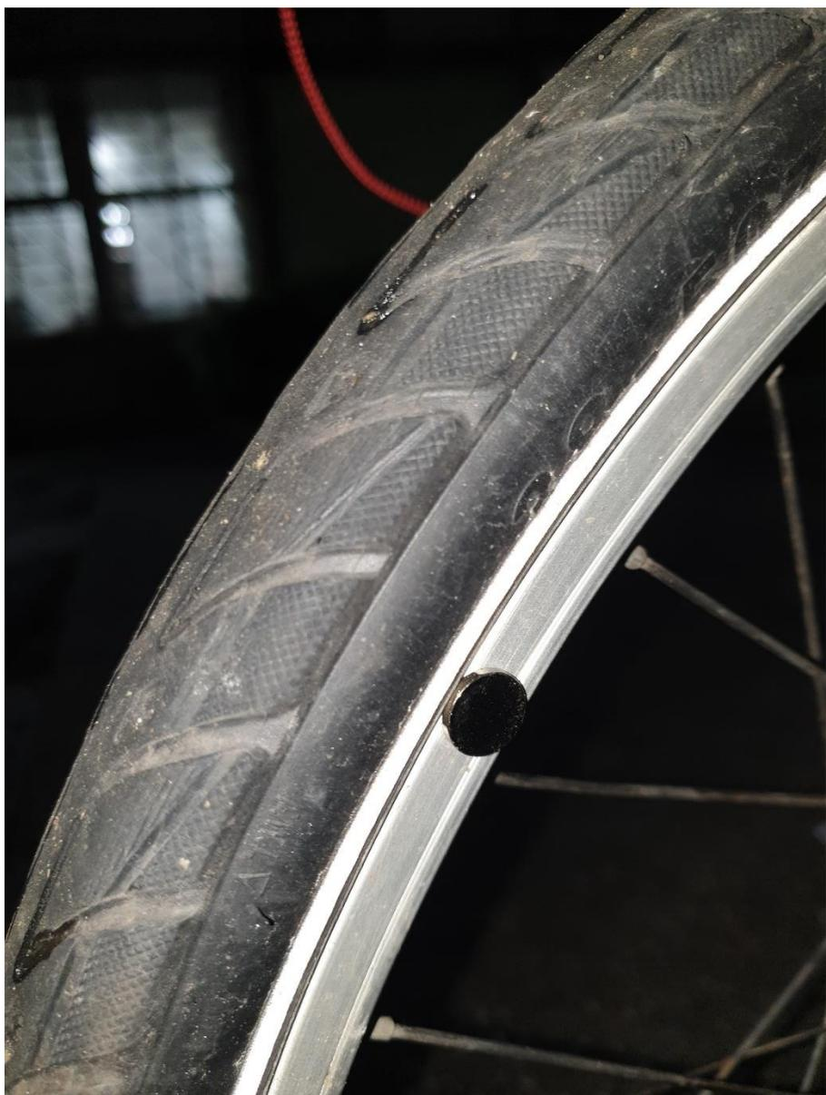
圖 15 四顆磁鐵吸在前輪鋁圈之四個角。
