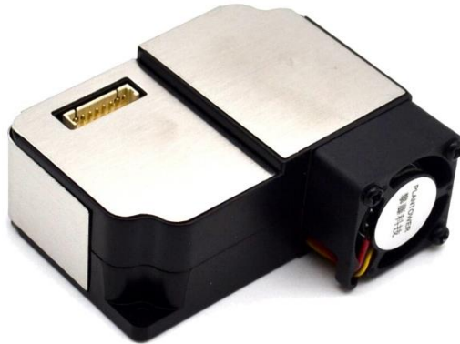
▲圖 3 PMS3003 空氣品質偵測模組
